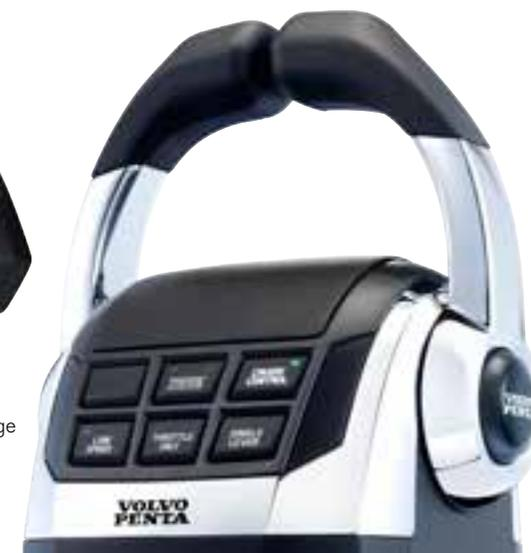
**MODE VITESSE LENTE** Réduisez la vitesse de votre bateau au ralenti d'environ 50 % pour un accostage et des manœuvres plus aisées. Intégré aux commandes standard.
